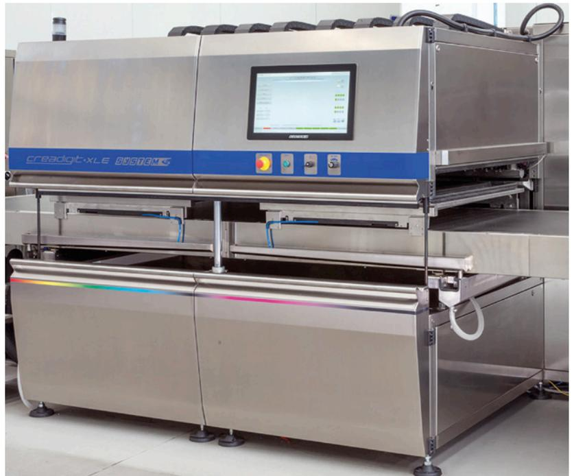
近年来，数字装饰确立了在陶瓷行业中的重要地位，为所有建筑应用提供创新型前沿的产品。生产设备中的施釉线现在几乎都配备为瓷砖装饰进行喷印颜色的数码打印机，瓷砖坯体就如同一张白纸，可以让人尽情发挥创造力，把它变成一个装饰表面。西斯特姆的Creadigit数码打印是价值不菲且高度创新的装饰工具，能够给予陶瓷表面前所未有的审美价值、情感价值和功能价值。
